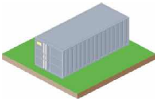
Контейнерный ЦОД (модульный контейнерного типа)
